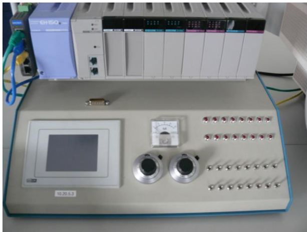
Onderwijsleermodel t.b.v. de Hitachi PLC's
